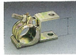
カエルマタクランプ ●規格/φ48.6・φ42.7兼用 A=45 穴径φ14.5 ●単重/620g・610g・610g
