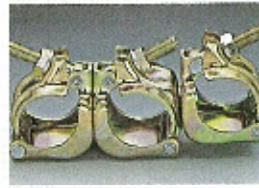
三連自在クランプ ●規格/ φ48.6×φ48.6×φ48.6 ●入数/20個 ●単重/1.05kg
